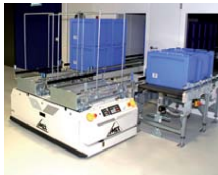
Фото 3. Работаящая без водителей транспортирующая система для удаления контейнеров из промежуточного шлюза
