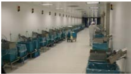
Фото 2. Чистое помещение в полуподвальном этаже для упаковывания поступающих по транспортирующим трубопроводам изделий
