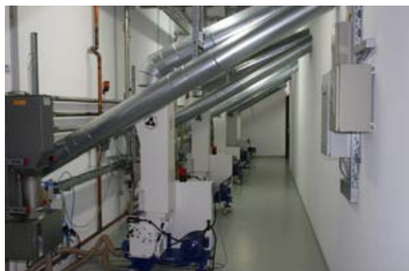
Фото 4. Участок в полуподвальном помещении, где производится раздельное измельчение поступающих от отдельных машин литников и брака
