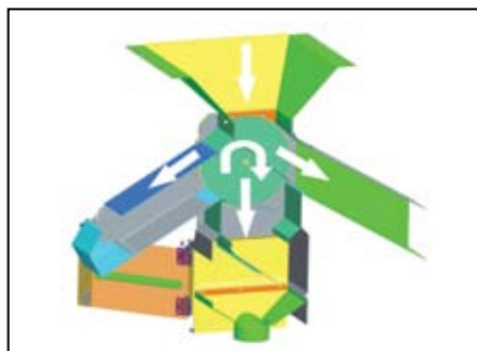
Рис. 2. Принцип действия барабанного сепаратора для отделения литников и брака от потока качественных изделий
